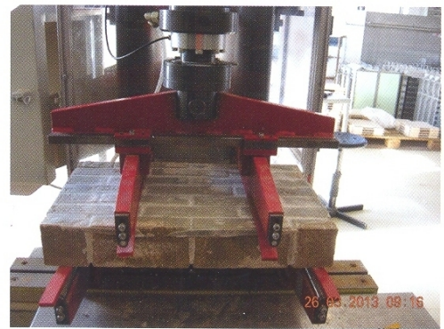
Foto 7: Buigtreksterkte gemetselde proefmuur
