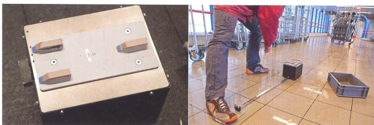
Foto 3 en 4: Opstelling en uitvoering tribometer-test
