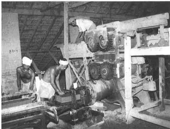
■ Foto 1 De fabricage van strengpersstenen tijdens de eerste proeven te Cochin.
