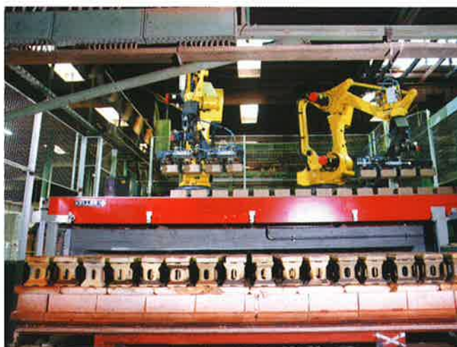
Foto 4: Het afnemen van de vormelingen door de robots
