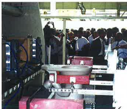
De vorming van de eerste drukgietmallen voor staande WC's
