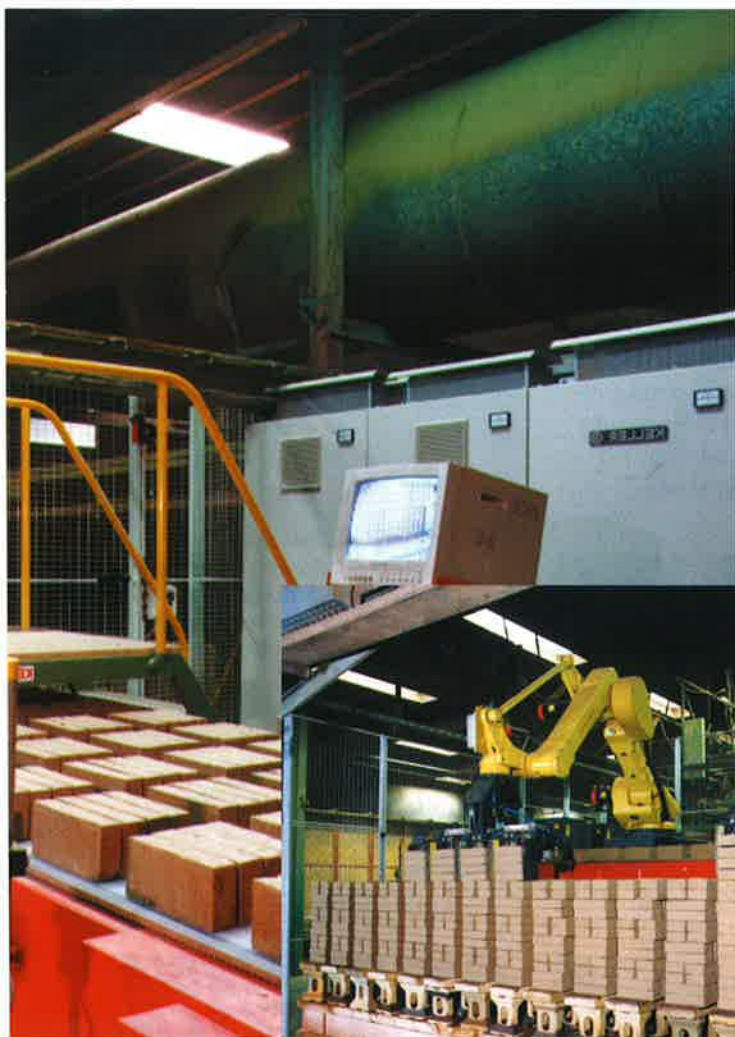
Foto 5: Het opbouwen van de torentjes op de tunnelovenwagen
