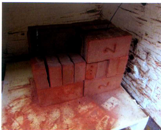
Foto 6: Opengelegd steenpakket bakproef 3 Rood
