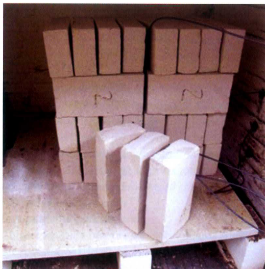
Foto 4: Resultaat bakproef 2 Wit met 15 gew.% zaagsel
