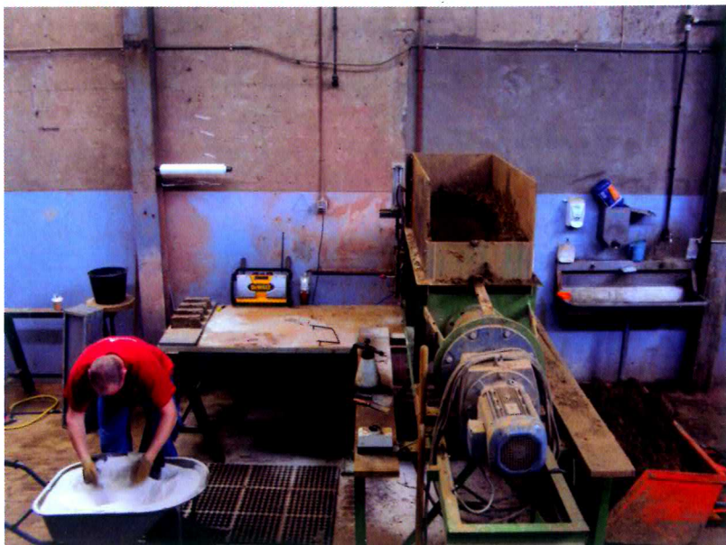
Foto 1: Klei/zaagselmenger en handvormproductie proefstenen
