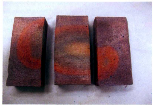
Foto 7: Reductievlekken stenen bakproef 5 Rood
