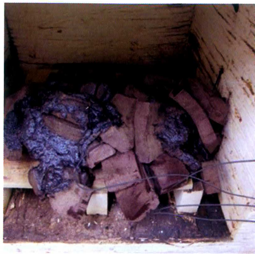
Foto 5: Productsmelt door te hoge toptemperatuur bij bakproef Rood
