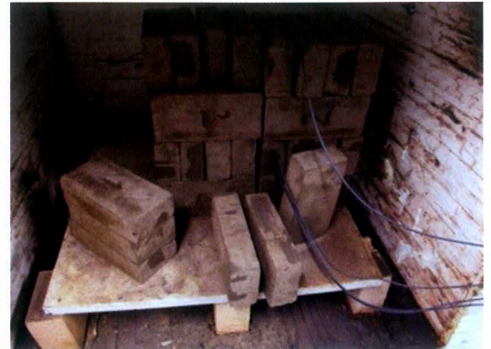
Foto 2: Pakketopstelling bakproeven met thermokoppels in laboratoriumgasoven
