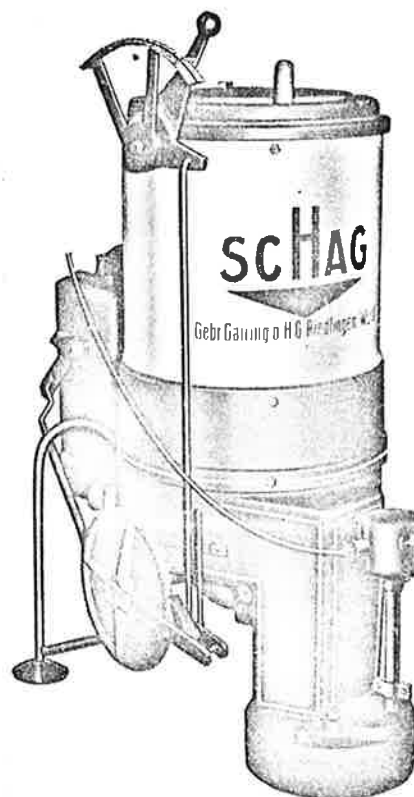
Afb. 6-23 : Het Schag-stookapparaat met electrohydraulische aandrijving.
